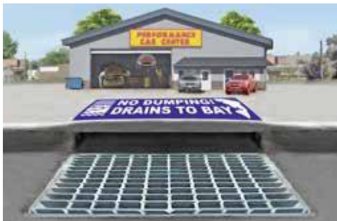
Alcantarilla: una alcantarilla externa que desemboca directamente en los arroyos y la Bahía.
