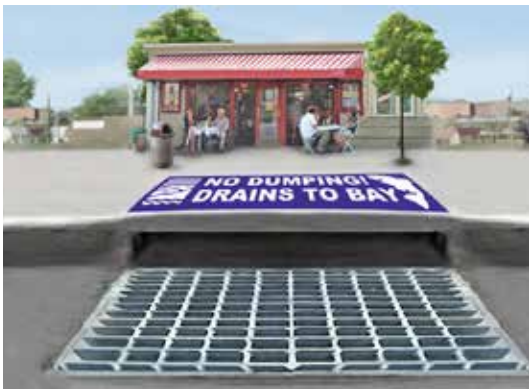
暴雨排水孔：直接流向溪流及海灣的室外排水孔。
